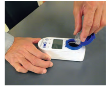
滓中の6価クロムを測定する水質測定器
